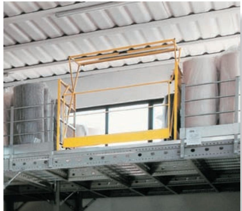
Per le operazioni di carico e scarico di materiale pesante, c'è un cancello scorrevole e/o basculante che facilita il lavoro.
